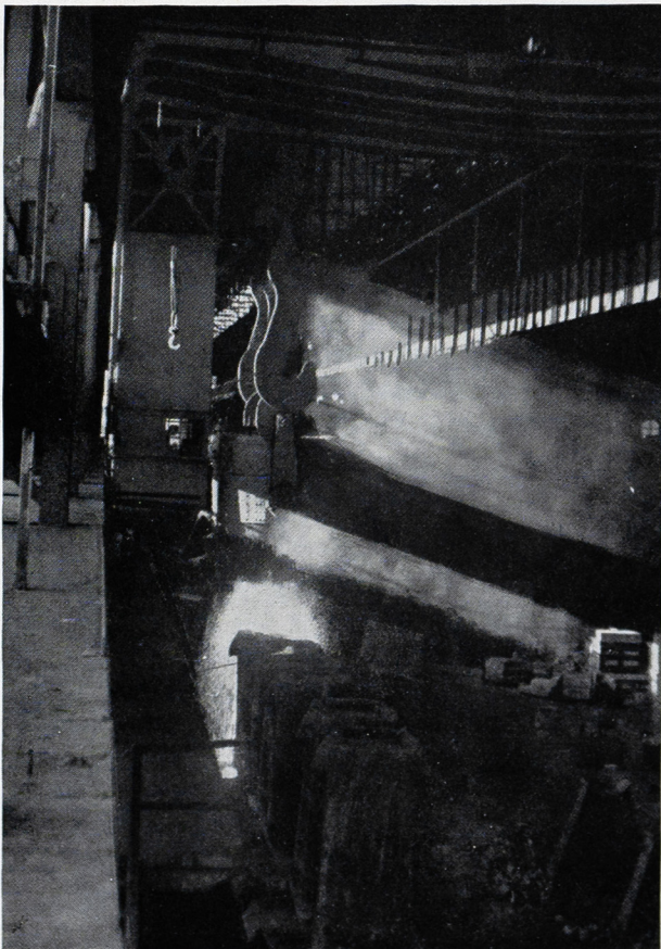
Llenado de lingoteras (Altos Hornos del Mediterráneo-Sagunto).
