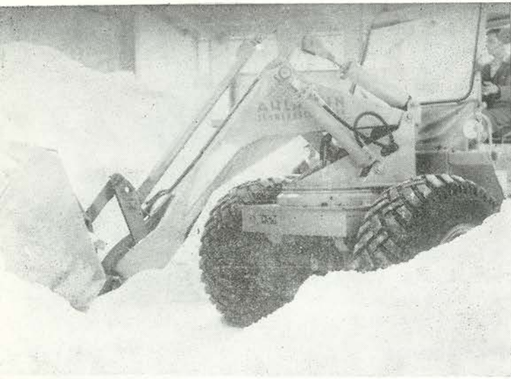
La sal húmeda a granel se amontona en el almacén con cegadora blancura y una pala cargadora mecánica es el instrumento utilizado para su cargue.
