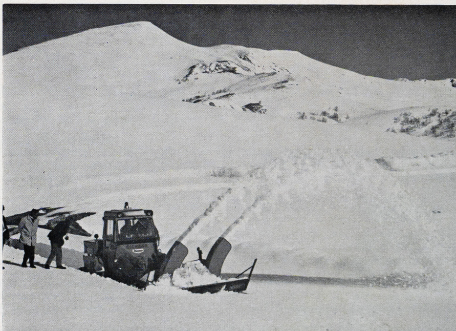
Vista de una máquina fresadora en trabajo de limpieza de una carretera.
